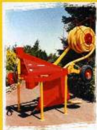
SUBSOLADORA 3 CUERPOS Chasis de 2,10 m) Altura bajo bastidor de 0,80 m con bola y opción ruedas limitadoras.
