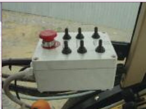
Comando eléctrico com caixa botoneira
