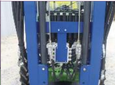
Comando eléctrico através de electroválvulas
