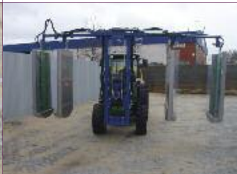
Regulação hidráulica independente da largura de trabalho entre painéis
