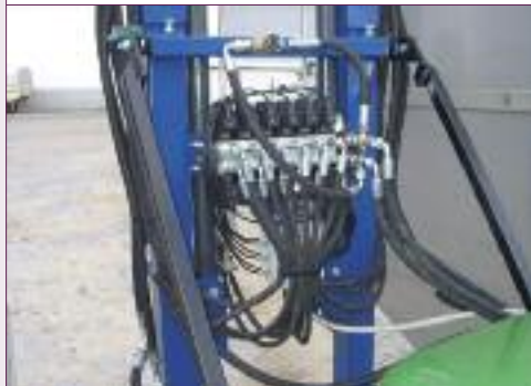
Regulação do caudal hidráulico da máquina
