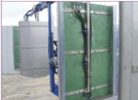
Recuperadores de calda com 1,50 mts de altura com 3 jactos de pulverização independentes
