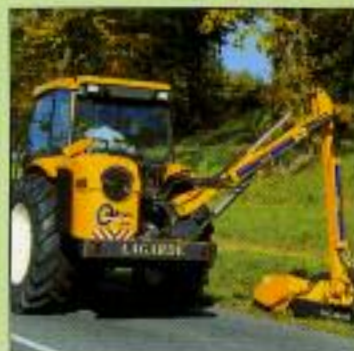
LIMPA-BERMAS ORION Alcance: 4,60 / 4,80 / 5,00 / 5,40 m Potência rotor: 52 cv Potência tractor: 75 a 90 cv
