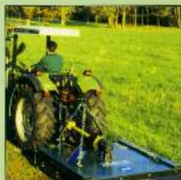
CORTA-MATOS GYRO GP Largura: 1,00/1,20/1,50/1,80 m Potência tractor: 25 a 75 cv
