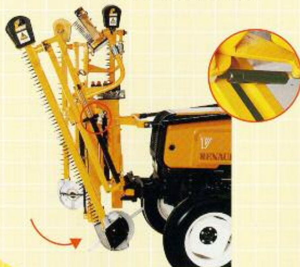
Seguridad choque frontal Botella de gas (inflado específico)
