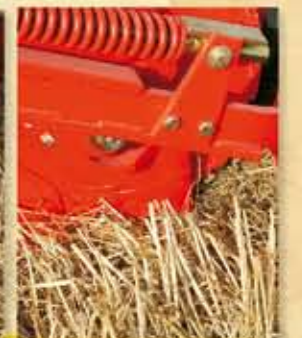
-RASTRA TRASERA REGULABLE CON PÚAS DOBLE V.
