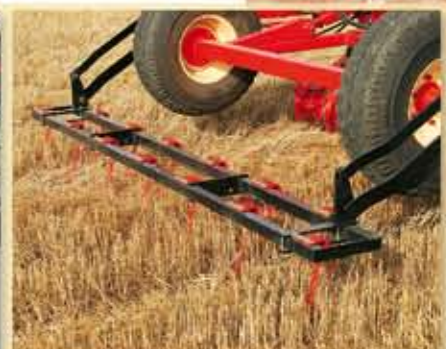
-RASTRA TRASERA REGULABLE CON PÚAS DOBLE V.
