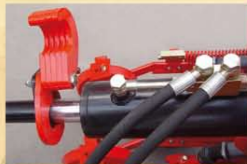
TOPES REGULABLES PARA VARIAR EL PESO DE LA MÁQUINA SOBRE LOS DISCOS ABRIDORES.
