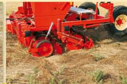
-DETALLES DE SIEMBRA BAJO CUBIERTA VEGETAL.
