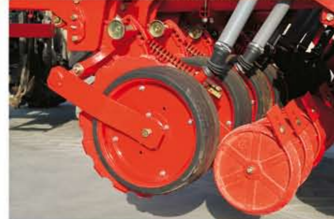
-RUEDA DE GOMA CON CONTROL REGULABLE DE PROFUNDIDAD.
