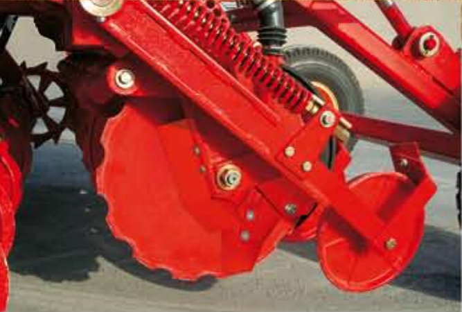
-CONJUNTO DE DISCO, BOTA Y RUEDA COMPACTADORA.
