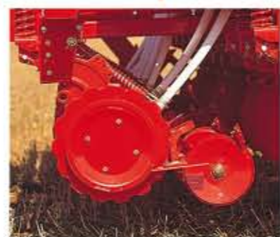
-RUEDAS CONTROL DE PROFUNDIDAD DE HIERRO.
