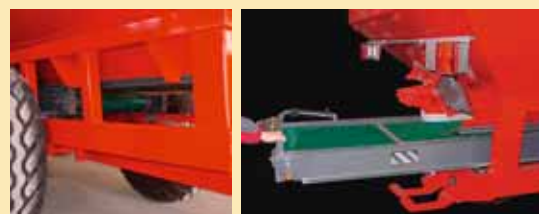
-TODO EL CONJUNTO DE BANDA TRANSPORTADORA SE PUEDE SACAR FÁCILMENTE HACIA ATRÁS PARA FACILITAR EL MANTENIMIENTO Y LA LIMPIEZA.
