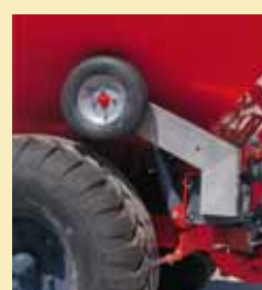
-MANDO HIDRÁULICO DE APERTURA Y CIERRE SINCRONIZADO CON LA RUEDA DE ARRASTRE DE LA CINTA.
